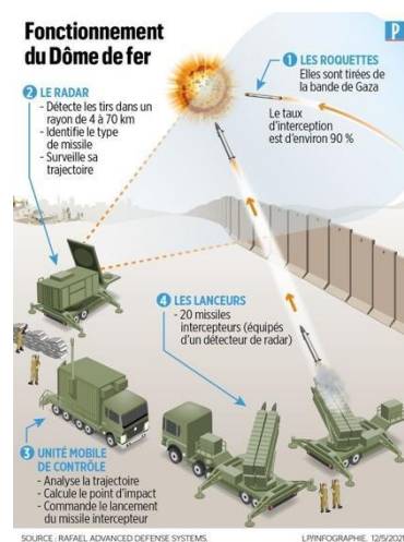
Figure 3 Schéma explicatif du fonctionnement du Dôme de fer d'Israël 5
