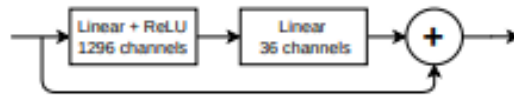
Fig. 5. Architecture d'une couche résiduelle de l'architecture de réseaux de neurones convolutifs hiérarchique top-down . Réseau et schéma réalisés par Baxter et al. (2021).
