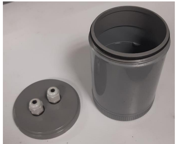
Figure 19 : Boîtier d'acquisition ouvert
