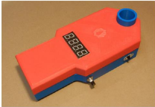
Figure 3 : Sonde de turbidité open-source proposée par Christopher D. Kelley et al., 2014
