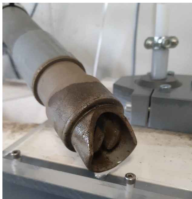
Figure 46 : Encrassement de la sonde après dix jours de fonctionnement
