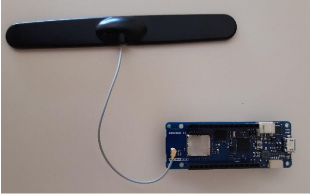
Figure 20 : Carte Arduino MKR Wan 1310 avec son antenne
