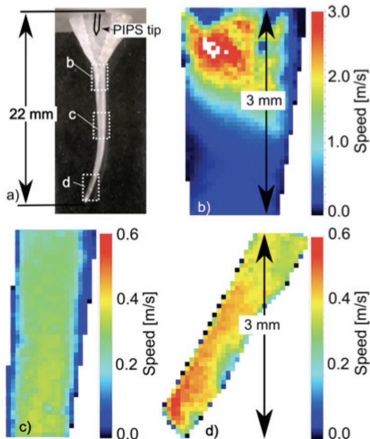
Figure 19 : L'image (a) montre le model de faux canal utilisé et la position du tip PIPS dans la chambre. Les images (b), (c), (d) montrent les vitesses obtenues au tiers coronaire, au tiers moyen, et au tiers apical lors de l'activation PIPS. (93)
