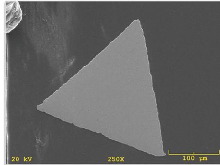
Figure 24 : Section triangulaire des instruments TF Adaptive™ au MEB.
