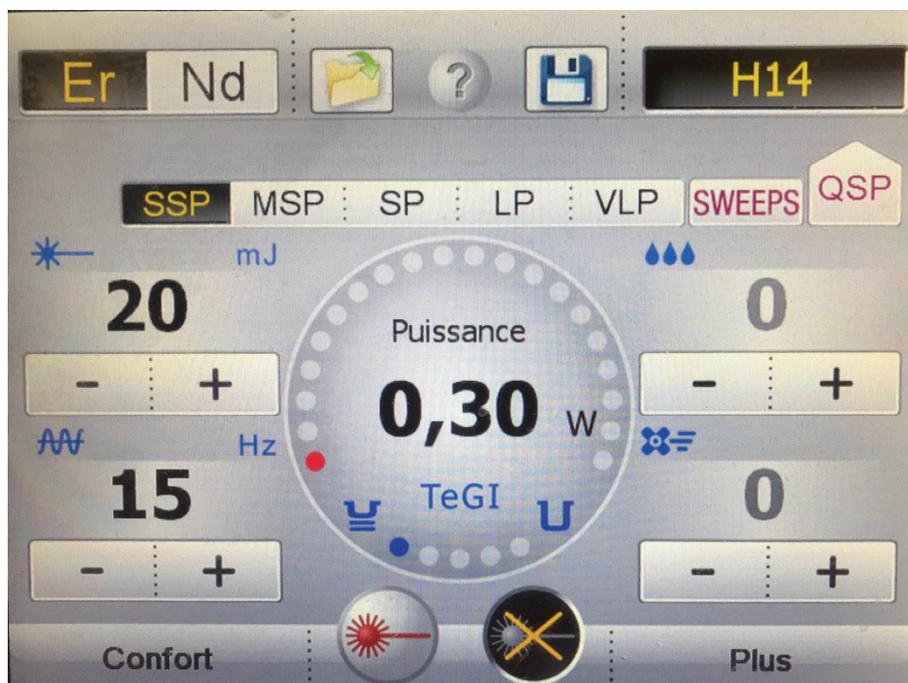
Figure 34 : Réglages PIPS du laser Er : YAG LightWalker ATS™ Fotona®.
