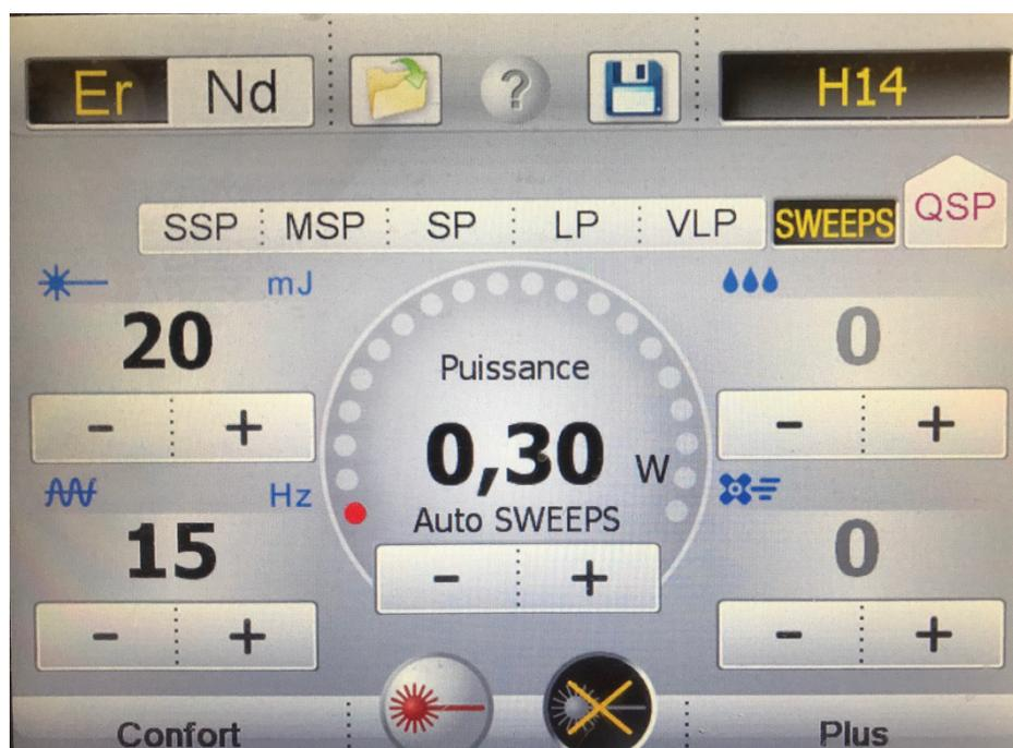
Figure 35 : Réglages SWEEPS du laser Er : YAG LightWalker ATS™ Fotona®.
