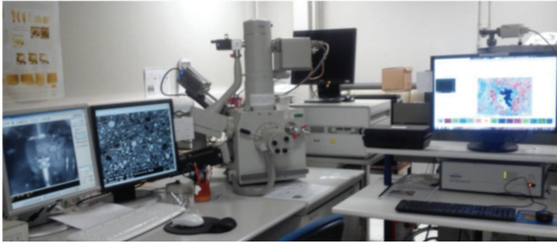
Figure 38 : Microscope Electronique à Balayage Philips XL30 ESEM du CEMEF à l'Ecole des Mines de Sophia-Antipolis.
