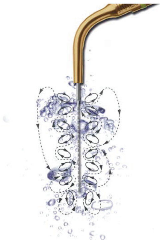
Figure 13 : Lime Ultrasonore IrriSafe™ - Illustration des noeuds et antinoeuds générant un microflux acoustique activant la solution d'irrigation.
