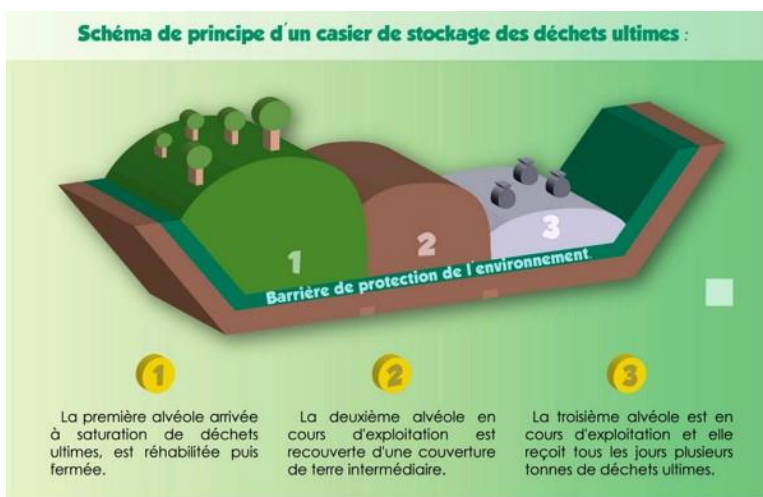
Figure 2 : Evolution d'un casier de stockage des déchets d'une ISDND (12)
