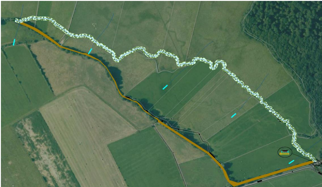
Figure 37 : Implantation et tracé de la remise en fond de talweg au droit des tronçons 1 et 2 (Source : IRH)
