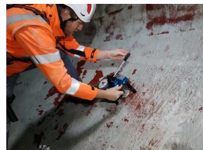
Mesure de la cohésion superficielle à l'aide d'un dynamomètre de traction
