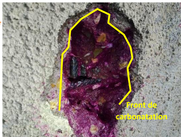
Figure 14 : Mesure du front de carbonatation avec présence d'armatures dans une zone non carbonatée
