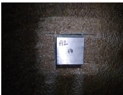
Collage d'une pastille à l'aide d'une colle bi-composant
