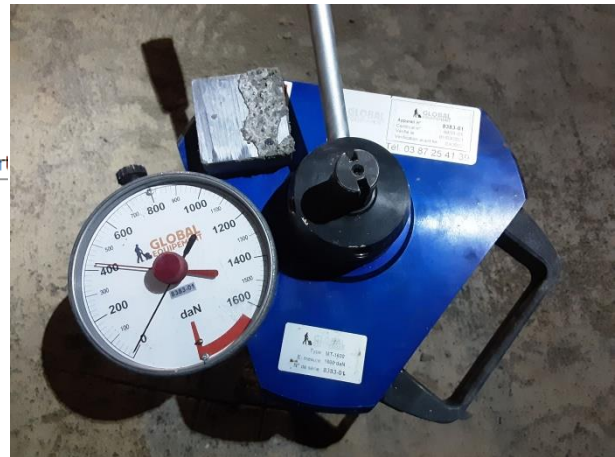
Figure 11 : Essai de cohésion superficielle du support
