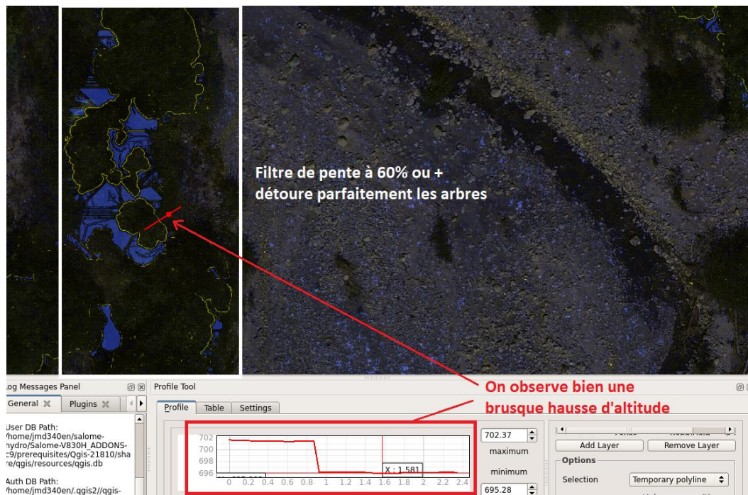
Figure 23 : Mise en évidence des erreurs de relevés topographiques par vol drone aux abords de la rypisylve (pente >60 %)
