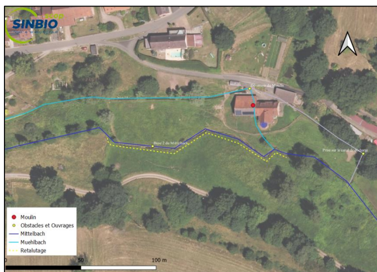
Figure 20 : Localisation du linéaire de berge à retaluter
