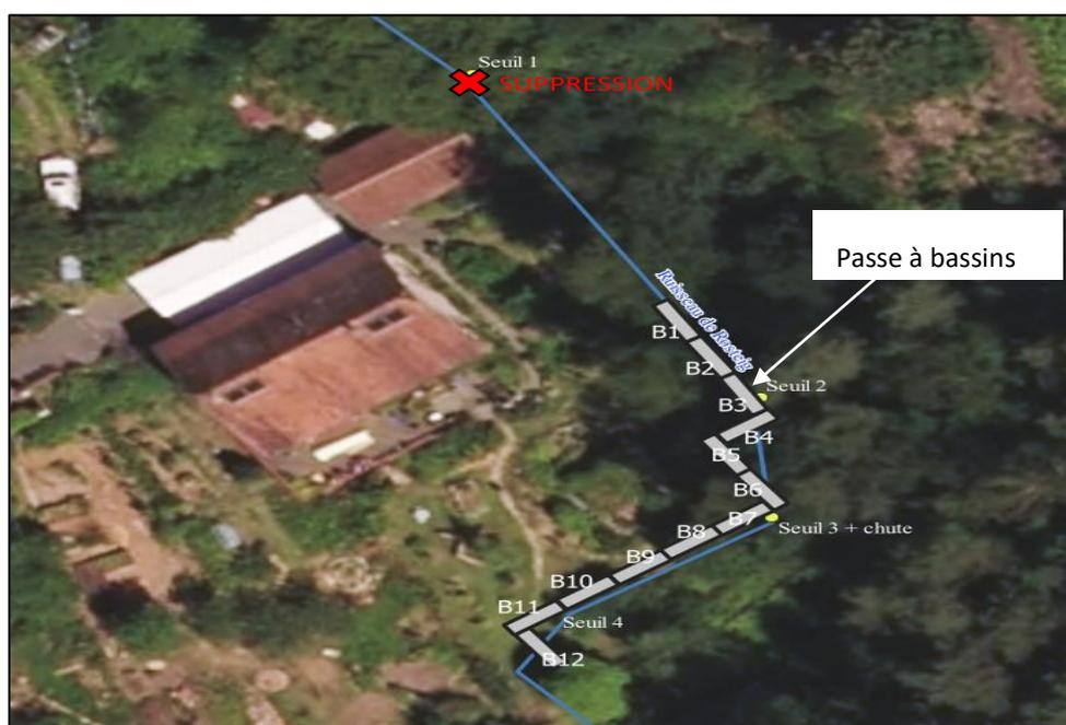
Figure 26 : Localisation schématique de la passe à bassins successifs en aval du seuil 1 jusqu'à l'aval du seuil 4
