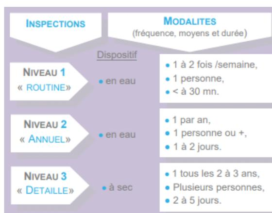
Figure 57 : Synthèse schématique des trois niveaux d'inspection (Guide VNF – 2008, p.50)
