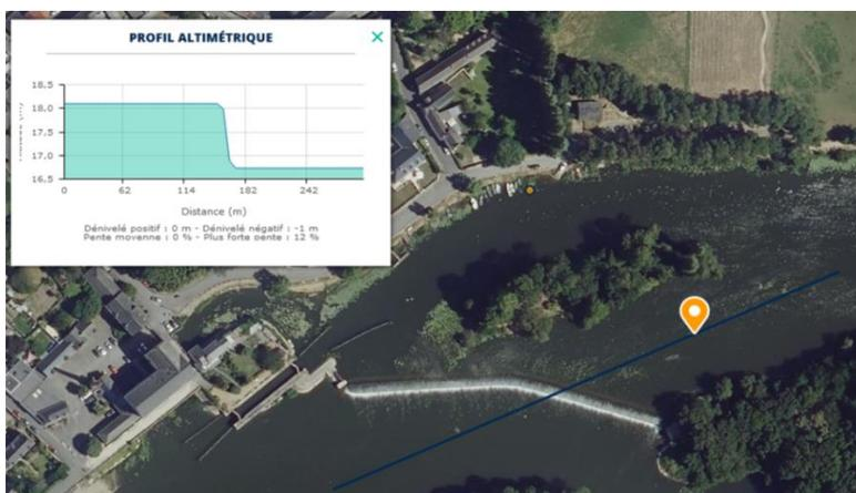
Figure 61 : Exemple de mesure de la hauteur de chute sur Géoportail (Archive NCA 2017 - Sarthe)
