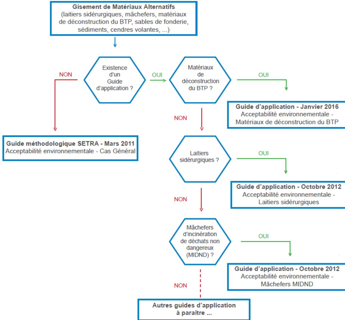
Figure 8 : schéma décisionnel d'un guide d'acceptabilité des matériaux alternatifs : exemple de méthodologie développée dans le guide relatif aux techniques routières et aux projets d'aménagement [Source : Note 32 de l'IDDRIM]
