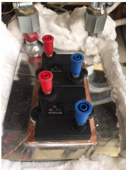
Figure 68 : Photographie du dispositif expérimental de caractérisation des plaques à eau (résistances montées sur plaque de cuivre assemblée sur la plaque à eau)
