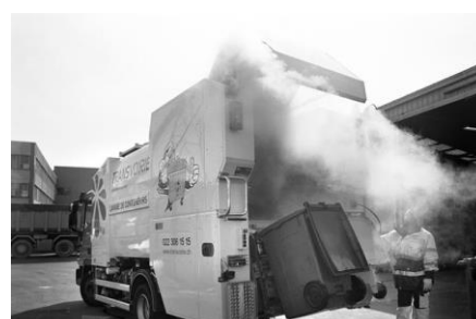
Figure 10. Camion de lavage des containers
