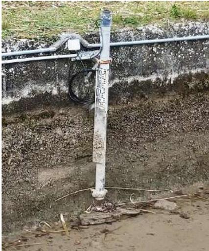
a) Sonde de mesure de niveau
