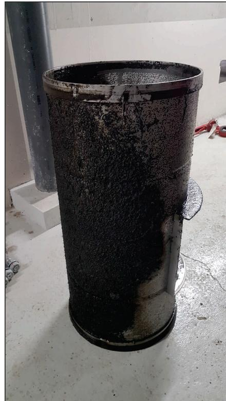
Figure 26: Filtre de la boucle de recirculation des flottateurs. Nous pouvons voir le hachage des boues causées par le balai du filtre. [Photo Alexis Larcade]
