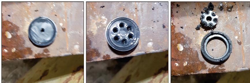
Figures 27, 28 & 29: De gauche à droite; Disque inférieur, disque supérieur, disque supérieur modifié. [Alexis Larcade]
