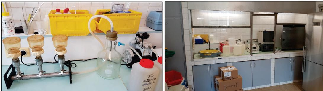
Figures 16 & 17: Laboratoire de la station d'épuration d'Antibes exploité par VEOLIA EAU. A gauche, l'atelier de filtration des MES. A droite, l'atelier d'étuvage pour les Matières Sèches et Volatiles. [Alexis Larcade]
