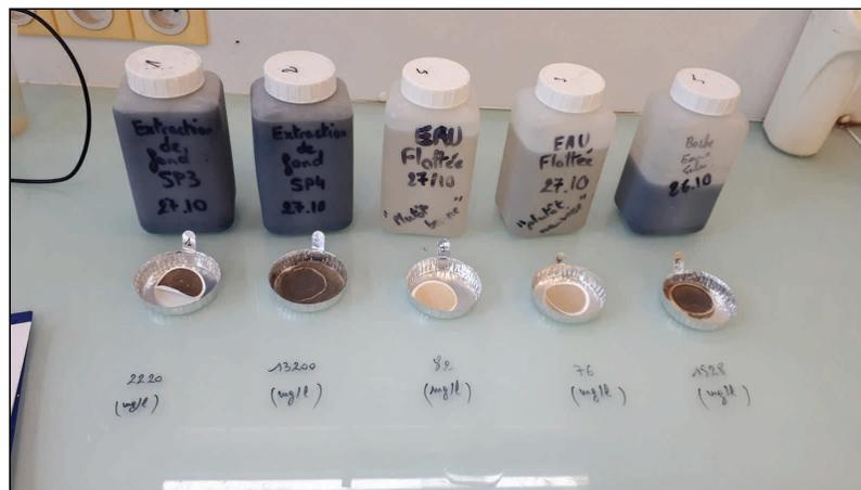
Figure 32: échantillons de différents points de prélèvement des flottateurs. De gauche à droite: Extractions de fond du flottateur 3; Extractions de fond du flottateur 4; Eau flottée "bonne"; Eau flottée "mauvaise"; Retours de bache eaux sales. [Samir EL-KAMEL]
