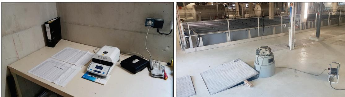
Figures 19 & 20: A gauche, laboratoire provisoire permettant de faire des thermobalances. A droite, préleveur mobile automatique pour l'eau en sortie de traitement primaire. [Alexis Larcade]
