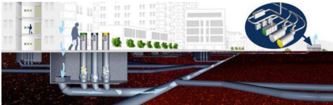
Figure 2 : Réseau CPOM (ENVAC)
