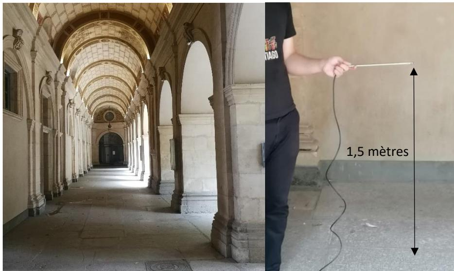
Figure 25 : A gauche, position de l'expérimentateur dans la galerie, à droite, hauteur de la sonde par rapport au sol
