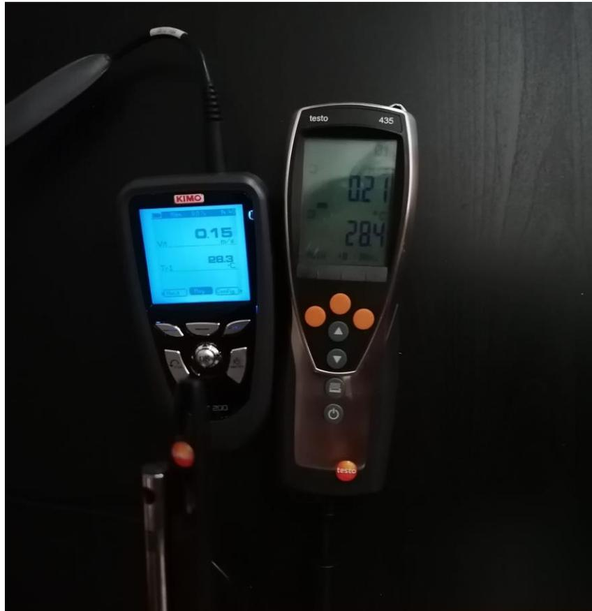
*Figure 22 : Vérification des valeurs affichées par les deux appareils de mesure*
