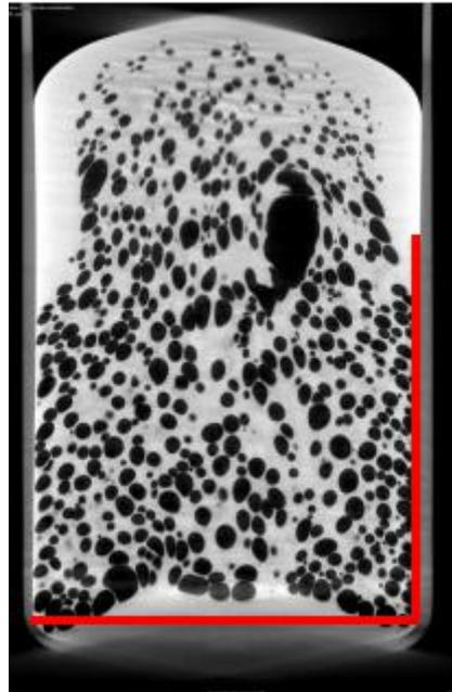
Figure 69 : Image obtenue par micro-tomographie aux rayons X d'un échantillon d'enrobé STE3 ayant intégré une dose de 1 MGy.
