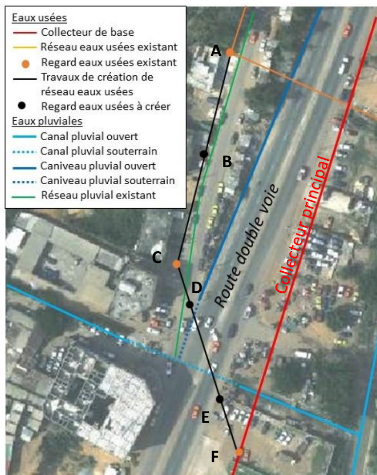
Figure 39 : Localisation des travaux et des difficultés rencontrées (les lettres renvoient au profil en long de la Figure 40)
