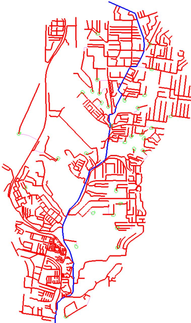
Figure 26 : Réseau modélisé sous Sewercad (bleu : collecteur principal, rouge : réseau secondaire, vert : stations de pompage)
