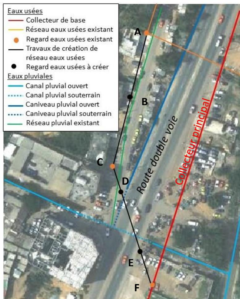
Figure 39 : Localisation des travaux et des difficultés rencontrées (les lettres renvoient au profil en long de la Figure 40)
