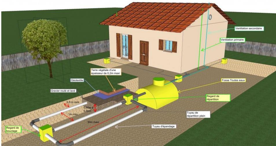
Figure 31 : Tranchées d'infiltration
