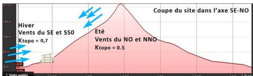
Figure 25 - Coupe su site du collège de Bouéni pour l'étude du potentiel de ventilation naturelle du terrain
