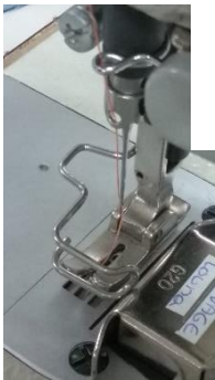
Pied presseur standard, plat utilisé par A. et B.
