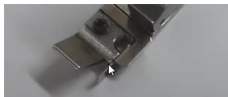
Photo 4 : décrochement du pied presseur nervure , prise lors des observations en atelier du Titre professionnel
