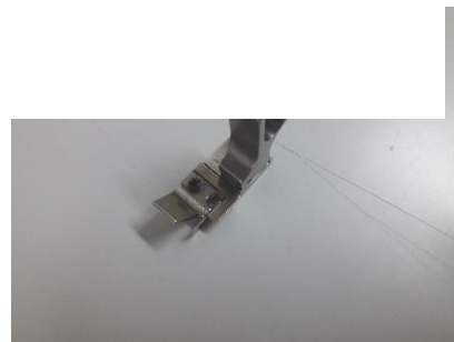
Pied presseur « nervure » utilisé par C
