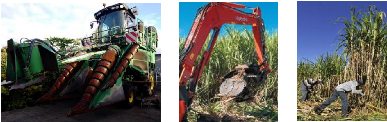
Figure 4 : Photos des différents modes de coupe (de gauche à droite) : Coupeuse tronçonneuse, Coupeuse péi, et coupe manuelle droite, (Paul Donadieu de Lavit, 2016 et Fanny Chevallier 2021)
