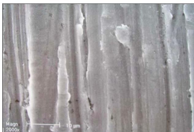
Figure 7 : Surface usinée observée à fort grossissement (x2000)<sup>23</sup>
