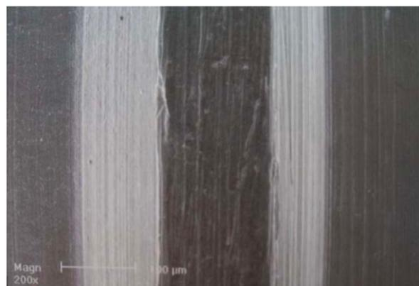
Figure 6 : Surface usinée observée à faible grossissement (x200)<sup>23</sup>
