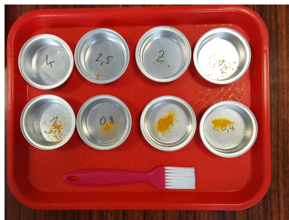
Figure 6 : Coupelles contenant les particules retenues par chaque tamis avant la pesée, et pinceau à poils synthétiques souples.
