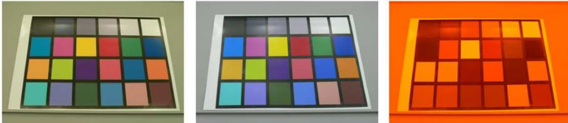
Fig.9. - Perception de mêmes échantillons de couleurs sous différentes sources d'éclairage.
