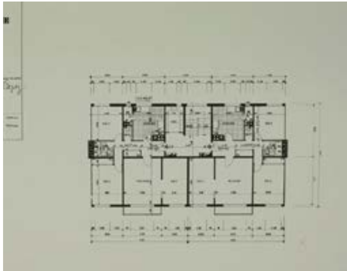
Fig. 24 : Z.U.P. du Val Fourré - Quartier 1, des Ecrivains. Plan des bâtiments de huit étages, cellules 4 pièces et 4 pièces. (Archives Nationales, Direction de l'Habitat et de la Construction, 19840091/58-59), GERTRUDE IDF
