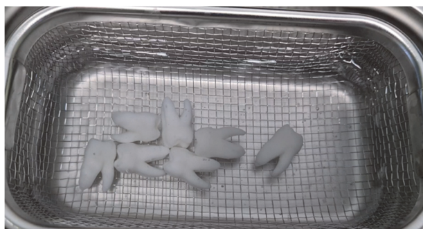
Figure 34 : Photographie des dents en résine lors du traitement aux ultrasons.
