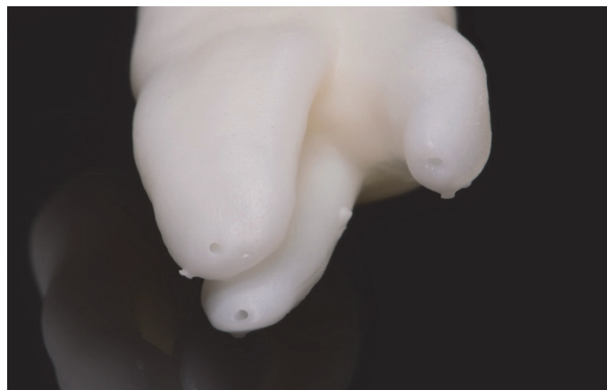
Figure 40 ci-dessus : Photographie de la dent imprimée en vue de dessous illustrant la précision des foramens apicaux. Notons les pics de résine près des foramens que sont les restes de supports détachés.
