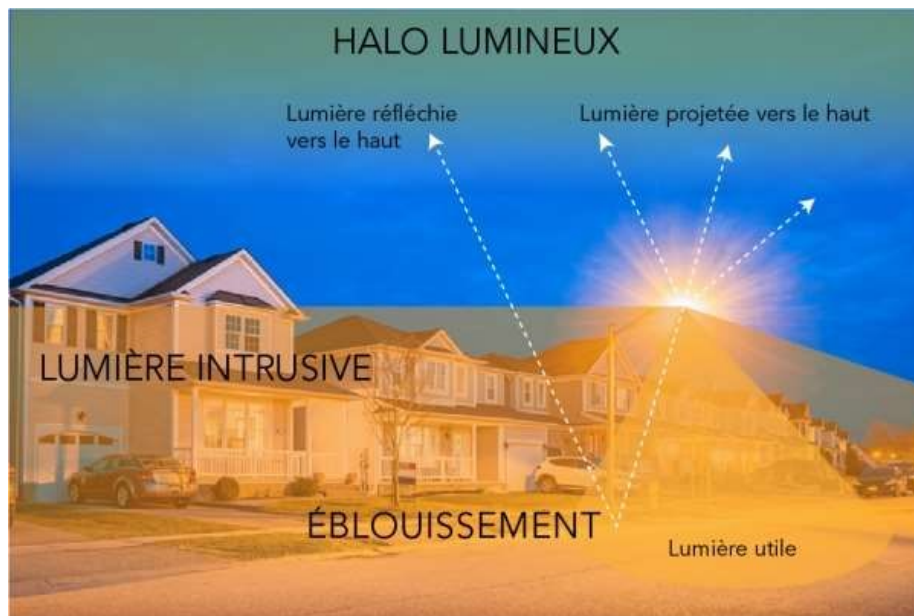
Figure 11 : La production de « halo lumineux » par les sources d'éclairage
