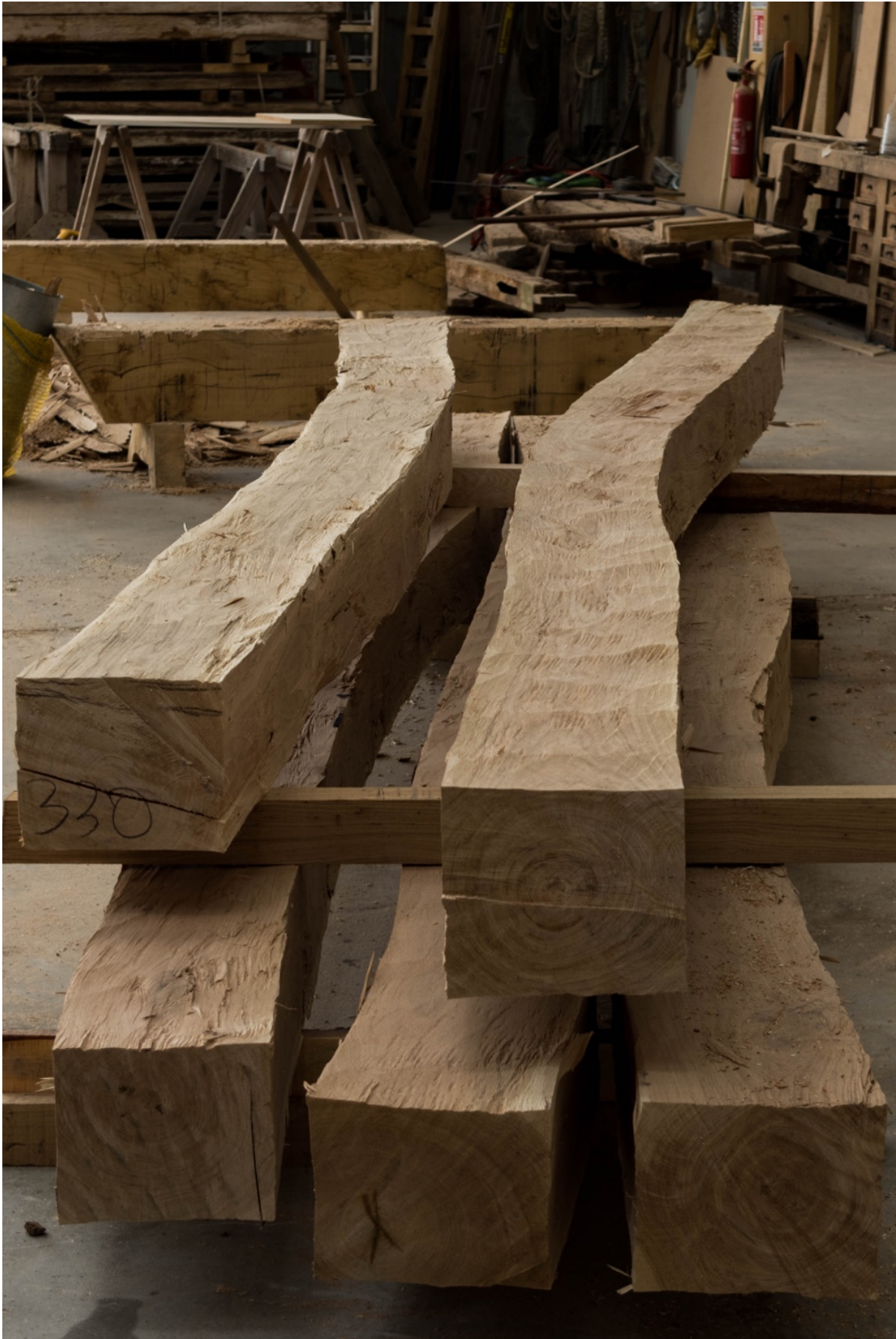
Figure 13 : Photographie de poutres de chêne courbes, équarries et en bois de brin. (L'usage de la doloire donne cette surface ondulée caractéristique)
