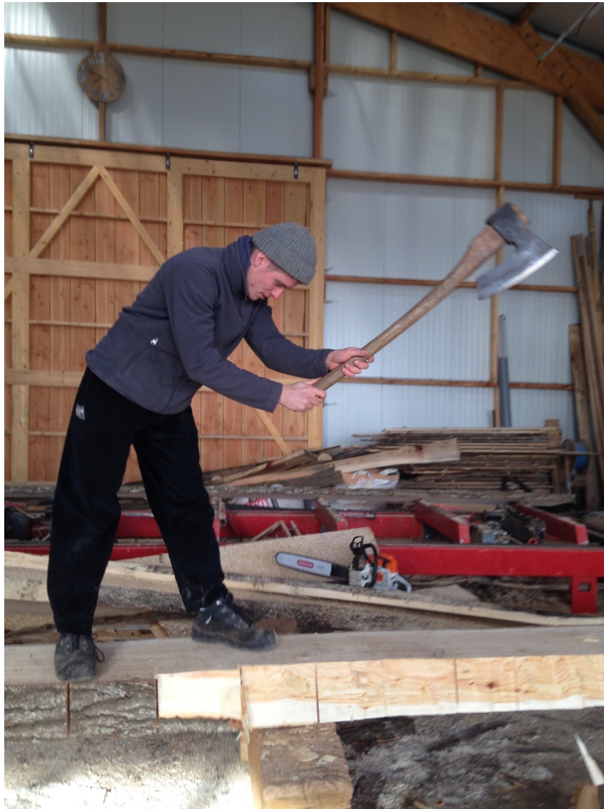
Figure 10 : Photographie du façonnage d'une future panne*en peuplier dans la SARL Desmonts.
