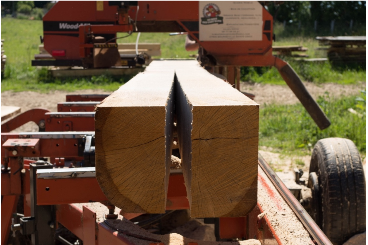
Figure 4 : Photographie de la déformation suite à la coupe de la scie. (La coupe traverse le cœur de l'arbre)
