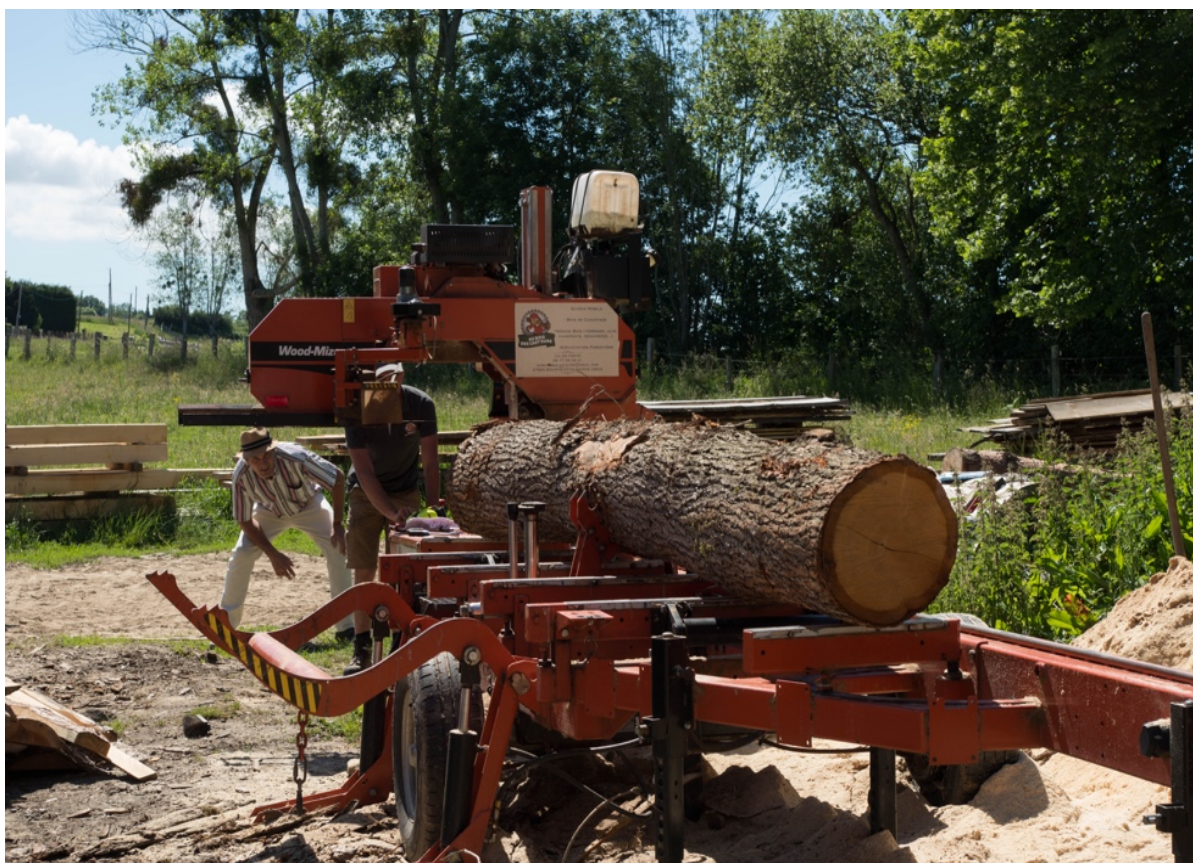
Figure 3 : Photographie de la scie mobile avec bille de chêne (Le scieur garde un œil permanent sur la coupe)
