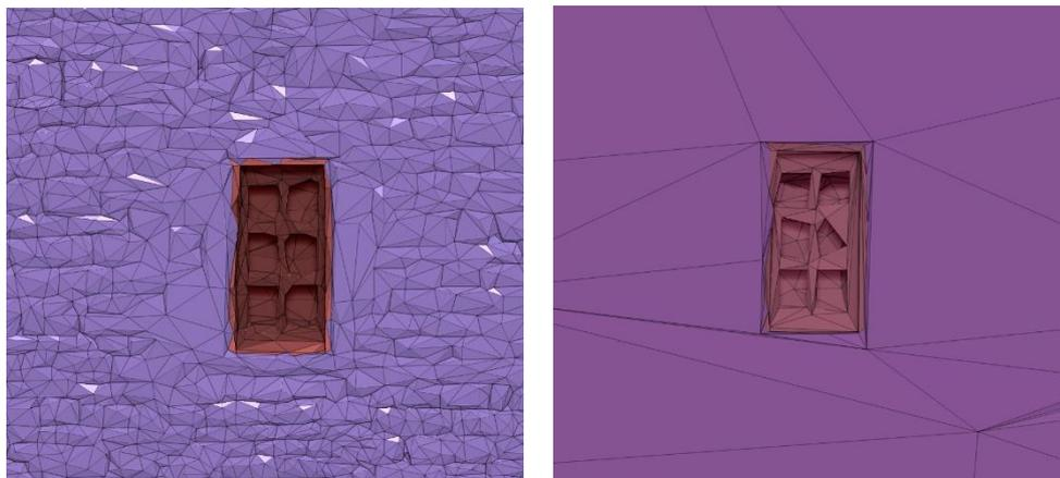
Figure 34 : Sans sélection manuelle de la fenêtre (à gauche), résultat après simplification (à droite)
