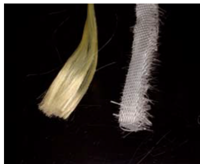
Figure 19 : Fibres de Kevlar uni-directionnelles (à gauche) et de polyéthylène tressé (à droite) (65)
