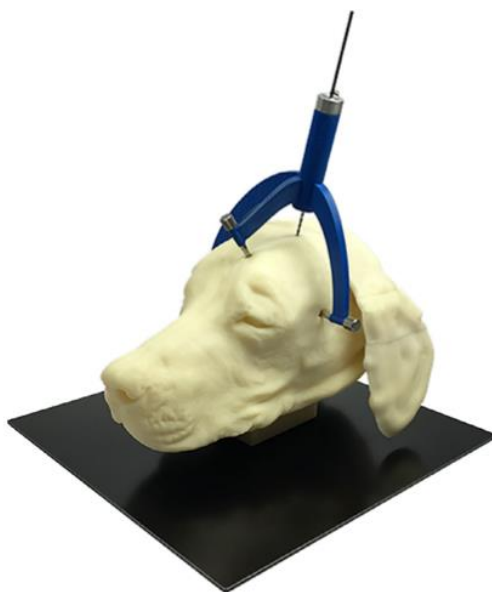
Figure 11 Dispositif personnalisé par impression 3D du système de fixation pour SBB basée sur IRM, d'après GUTMANN (2020) [60]
