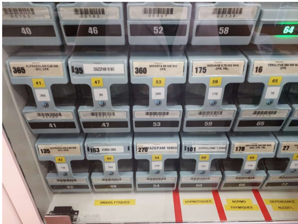
Figure 46 : Exemple de l'organisation des cassettes par classe thérapeutique dans l'automate de Sainte-Marie.
