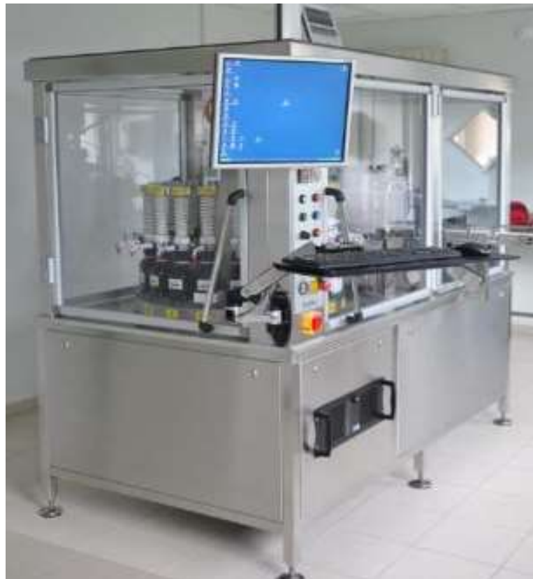
Figure 26 : Automate pour formes orales liquides de la marque Packinov (35)
