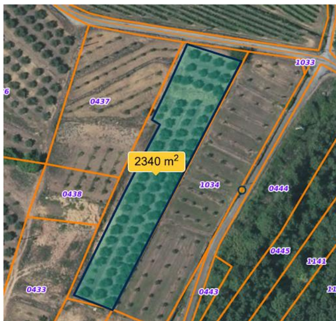
Annexe 13 : Exemple de calcul de surface d'une parcelle détournée avec l'outil « Mesurer une surface » de Géoportail
