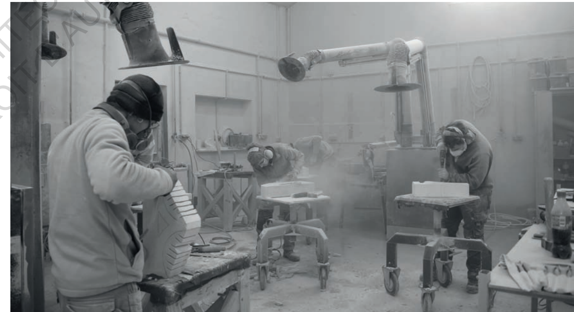
Ⓔ Balustrade travaillée par les apprentis compagnons en CAP à Saumur. Chacun travaille sur un morceau de balustrade qui sera ensuite assemblée.
