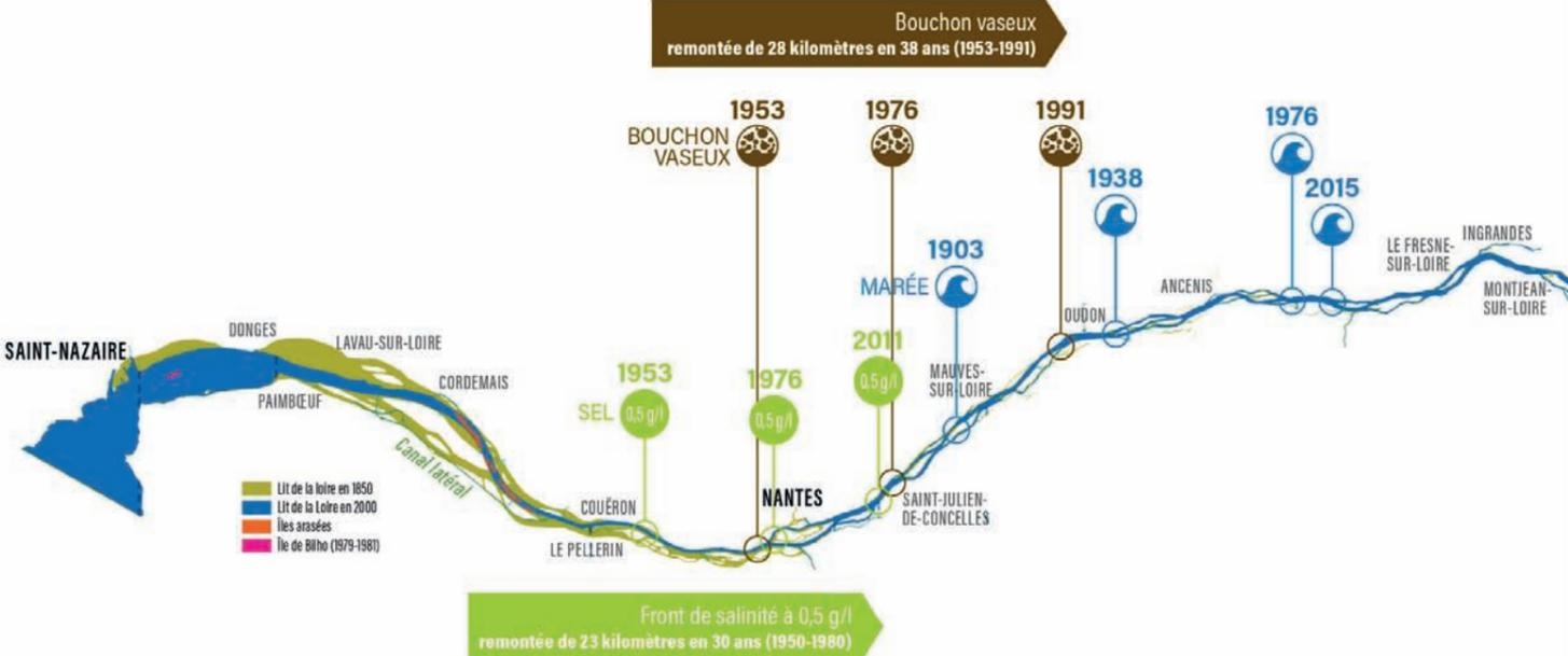
Fig. 48 : La remontée du bouchon vaseux et du front de salinité au cours du temps.
