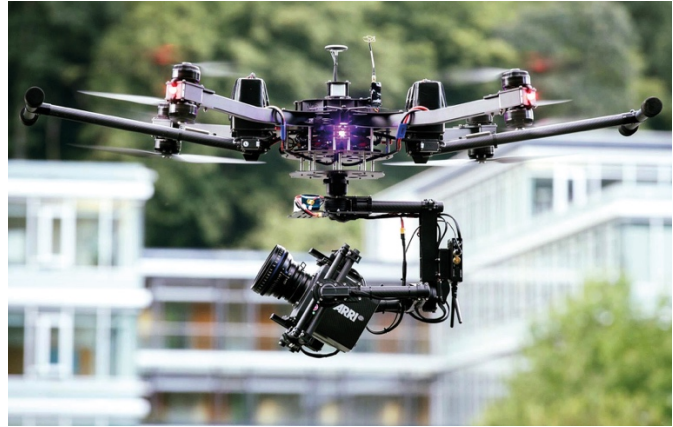
Alexa mini embarquée sur un drone 34
