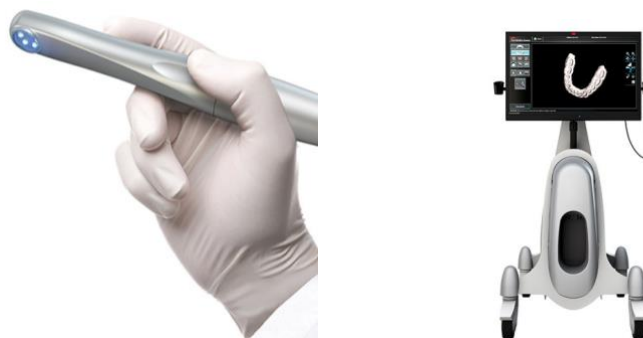
Figures 12 : Scanner optique intra-oral 3M™ True Definition Scanner avec son moniteur sur roulette. Source : internet libre de droit
