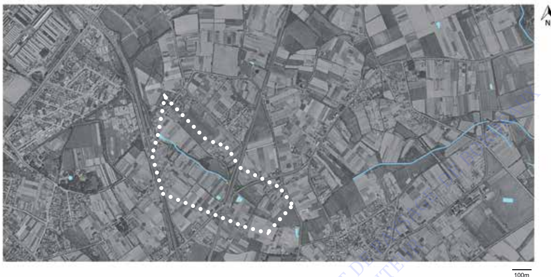
Figure 10: Plan du réseau hydrographique (bassins, lit du ruisseau des Gohards, noues et fossés) de la ZAC Bottière-Chênaie de Bruel Delmar, 2003.
