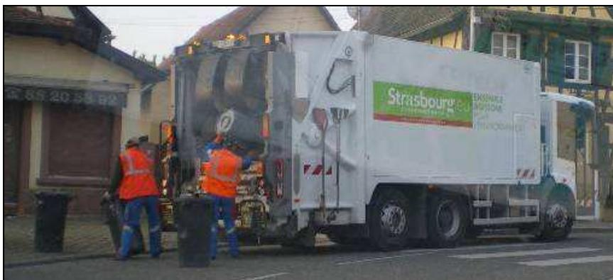
Figure 21 : « Bennage à la main » et non-utilisation du lève-conteneur avec des bacs de 110l
