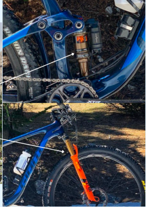
Figure 28 : Photos d'un VTT de montagne et zoom sur les suspensions (Antoine Phillip)(85)
