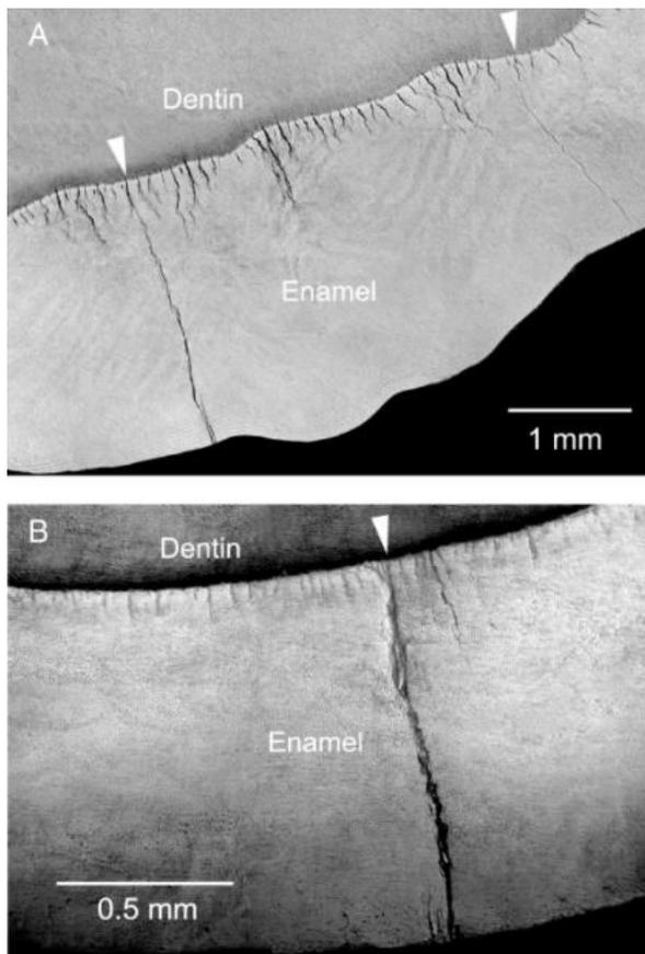
Figure 17 : Segment de vue en coupe transversale à travers les molaires humaines (A) et loutre de mer (B). Les fissures ont pour origine les touffes. On voit ici que la propagation des fissures ne se crée pas sur les autres touffes.. D'après Herzi Chai et al. (32).
