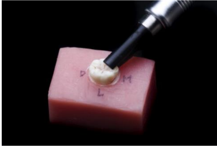
Figure 23 : Test de diagnostic quantitatif par percussion (QPD) sur la cuspide mésio-vestibulaire d'une molaire d'après Sheet et al. (71)
