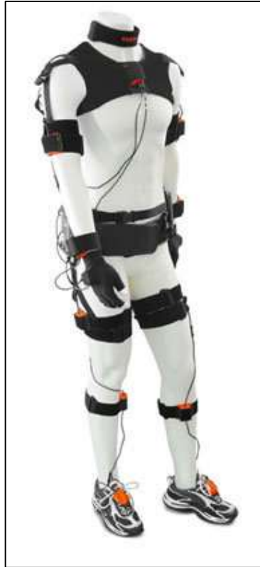
Figure 22 – Disposition et localisation des capteurs de Mouvement Xsens ® sur le corps
