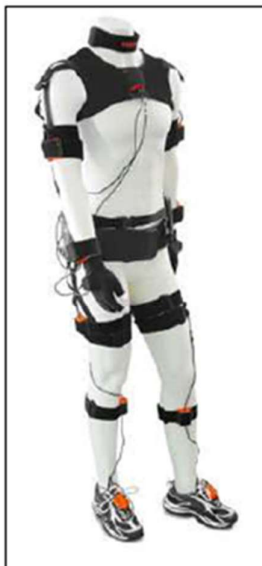
Figure 4 – Disposition et localisation des capteurs de Mouvement Xsens® sur le corps
