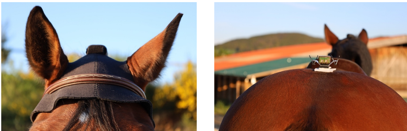
Figure 30 : Accéléromètres positionnés dans leurs étuis, sur la tête du cheval (à gauche) et sur le pelvis du cheval (à droite). (Photos J. Urlacher)
