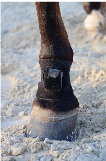
Figure 29 : Gyroscope dans son étui, placé sur la face dorsale du paturon du membre antérieur droit. (Photo J. Urlacher)
