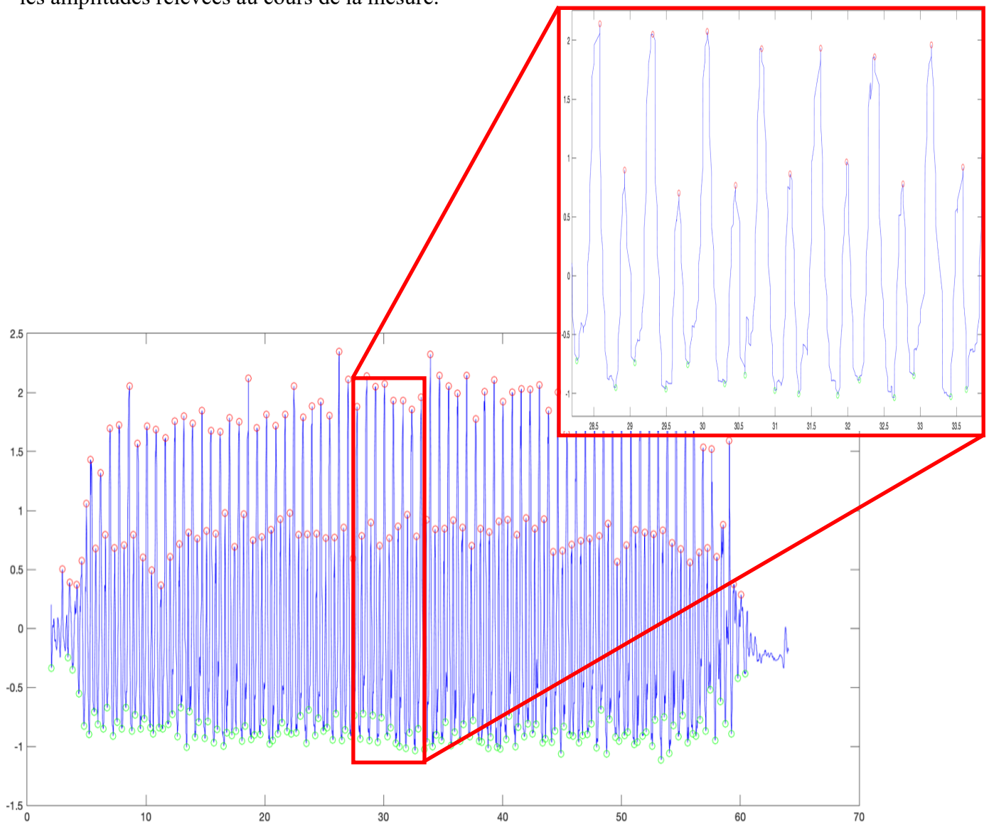
Figure 42 : Repérage des extremums du mouvement vertical de la tête d'un cheval boitant de l'antérieur gauche sous Matlab. Chaque cercle rouge repère un extremum haut, et chaque cercle vert représente un extremum bas. Cela permet de calculer les amplitudes de chaque mouvement de tête. Ces amplitudes sont ensuite stockées dans un tableur Excell.
