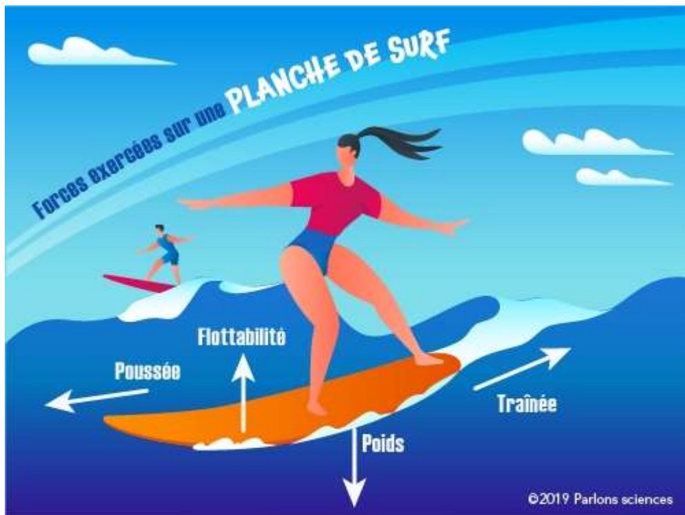
Les quatre forces exercées sur une planche de surf (© 2019 Parlons sciences)
