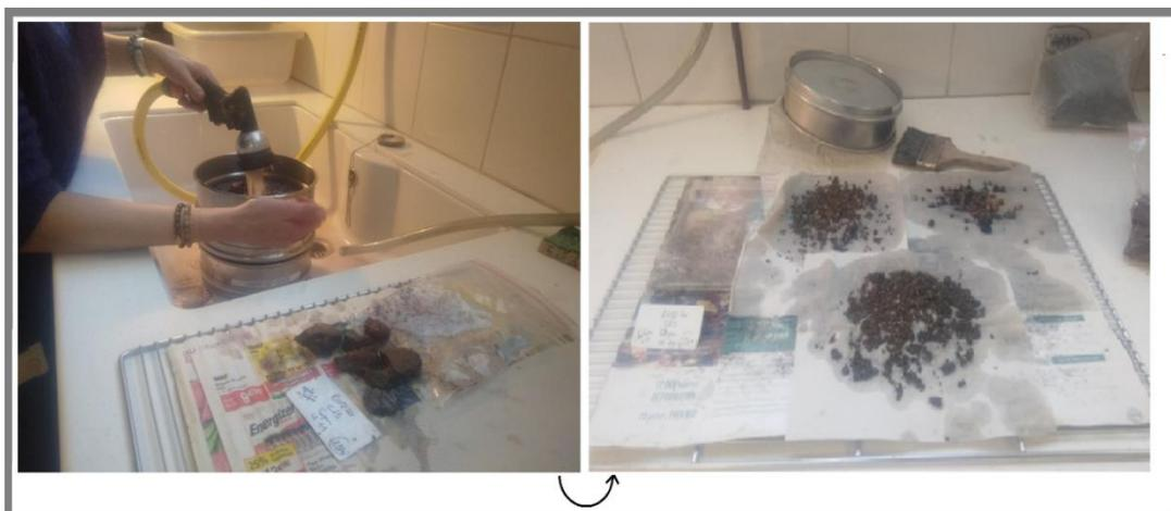
Fig. 15 - Tamisage de sédiments dans un laboratoire de l'UMR
