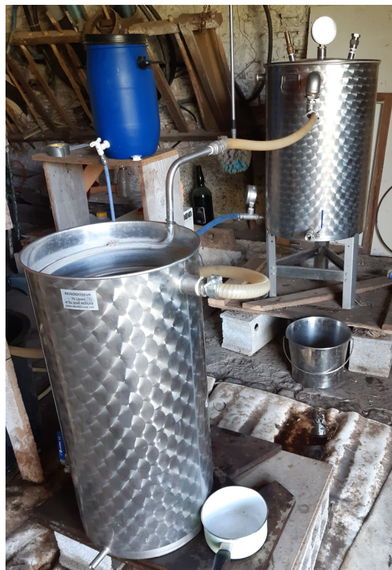
Figure 29. L'alambic : condensateur au premier plan, et cuve en arrière-plan, 01/10/21, Jardins d'Anahita (64400)
